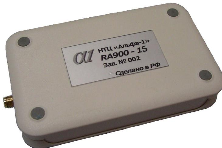
Ридер **RA900-15** является считывателем RFID российского UHF диапазона. Он предназначен для считывания и записи пользовательской информации в пассивные метки европейского UHF RFID диапазона.
